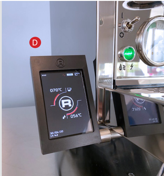
Fig. D. Introduzca el control remoto en el puerto serie en el lateral de R-CINQUANTOTTO o R 60V con la máquina apagada.
